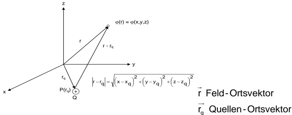
Bild: Berechnung der Potentialfunktion einer Punktladung
