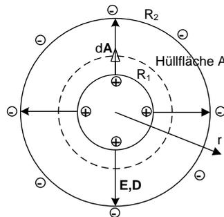
Bild: Kugelkondensator (gesamte Ladung befindet sich auf der Innenelektrode)
