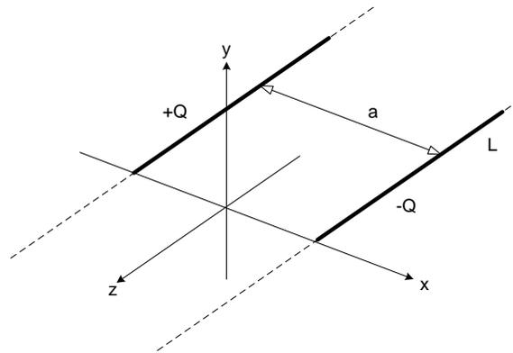
Potentialverteilung im Feldraum wird durch Überlagerung der den beiden Linienladungen zuzuordnenden Potentiale bestimmt (Superposition).
