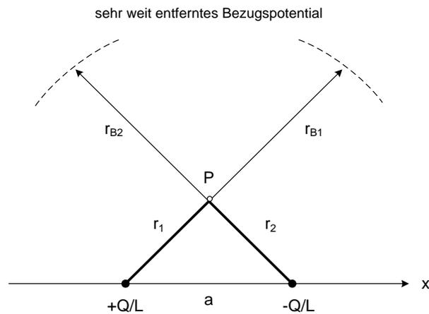
Für die Überlagerung der Potentiale  $\varphi_1$  und  $\varphi_2$ , die den Ladungen  $+Q$  und  $-Q$  zugeordnet werden, gilt in einem beliebigen Punkt  $P$  (der  $xy$ -Ebene):
